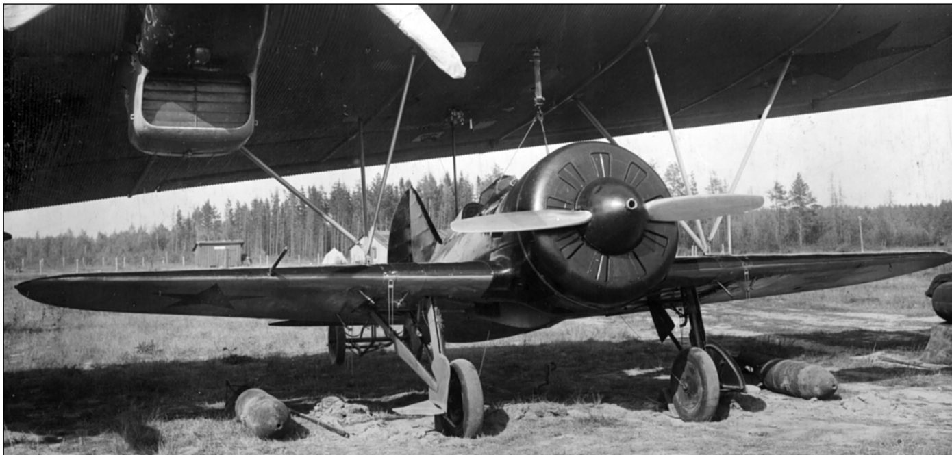
И-16 подкатали под крыло ТБ-3. Система подъема при помощи лебедки установлена, осталось натянуть трос, зафиксировать замки и убрать шасси. Как видим, для соединения пирамиды с крылом истребитель пришлось немного «понизить», для чего под колесами прокопали небольшие ямы. Корпуса авиабомб находятся несколько в стороне
