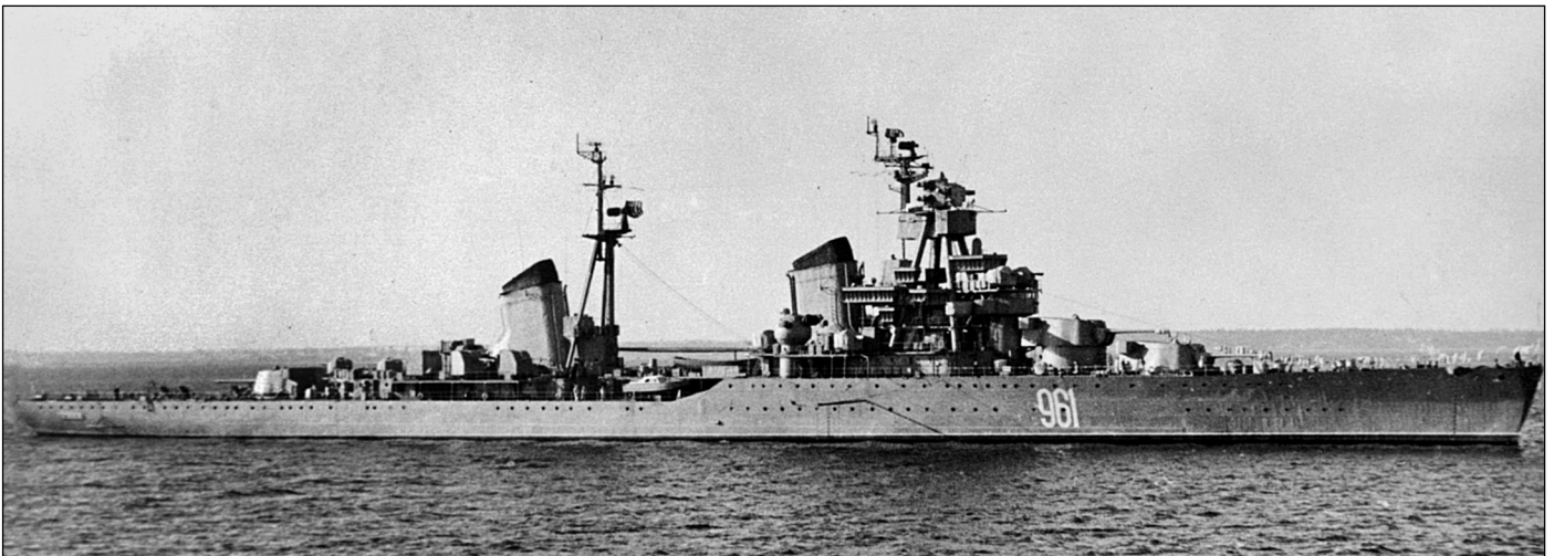
Крейсер «Киров» в 1960 г. Хорошо видно, что в ходе восстановительного ремонта после подрыва корабля на mine в 1945 г. силуэт претерпел заметные изменения — в частности, грот-мачта была перемещена в нос, перед второй дымовой трубой
