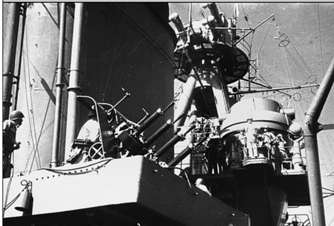
Установленные в декабре 1942 года на «Ворошилове» 37-мм автомат 70-К и 12,7-мм счетверенный пулемет «Виккерс»
