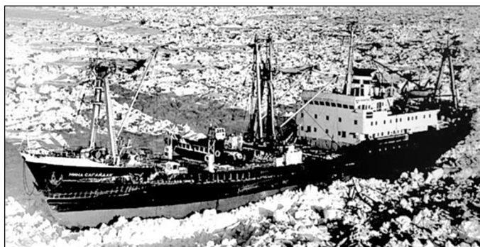
«Нина Сагайдак» дрейфует в проливе Лонга. С судна уже снят экипаж, с поступлением воды уже никто не борется, поэтому теплоход сильно сел кормой. На крышке трюма №2 находится плашкоут, перевозимый в качестве палубного груза. 8 октября 1983 г.
