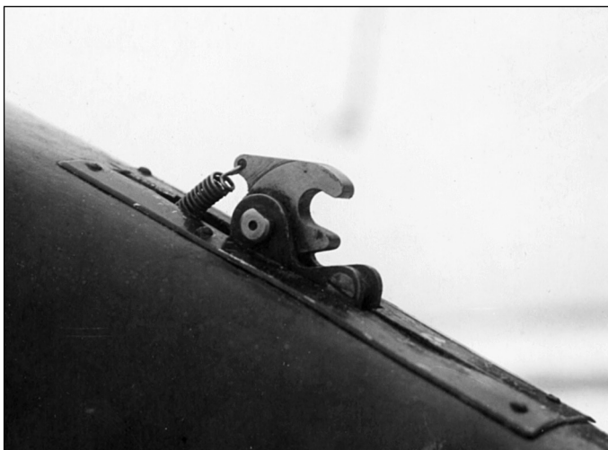
Слева: задний замок, установленный на 8-й раме И-16, в открытом положении. Справа: место стыка центроплана и отъемных частей крыла на И-16 при снятой стыковой ленте. Снят и обтекатель ранее стоящих пулеметов. Зато теперь неплохо видны элементы крепления авиабомбы
