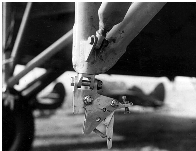
Левый передний замок крепления И-16 на пирамиде, оборудованной на ТБ-3
