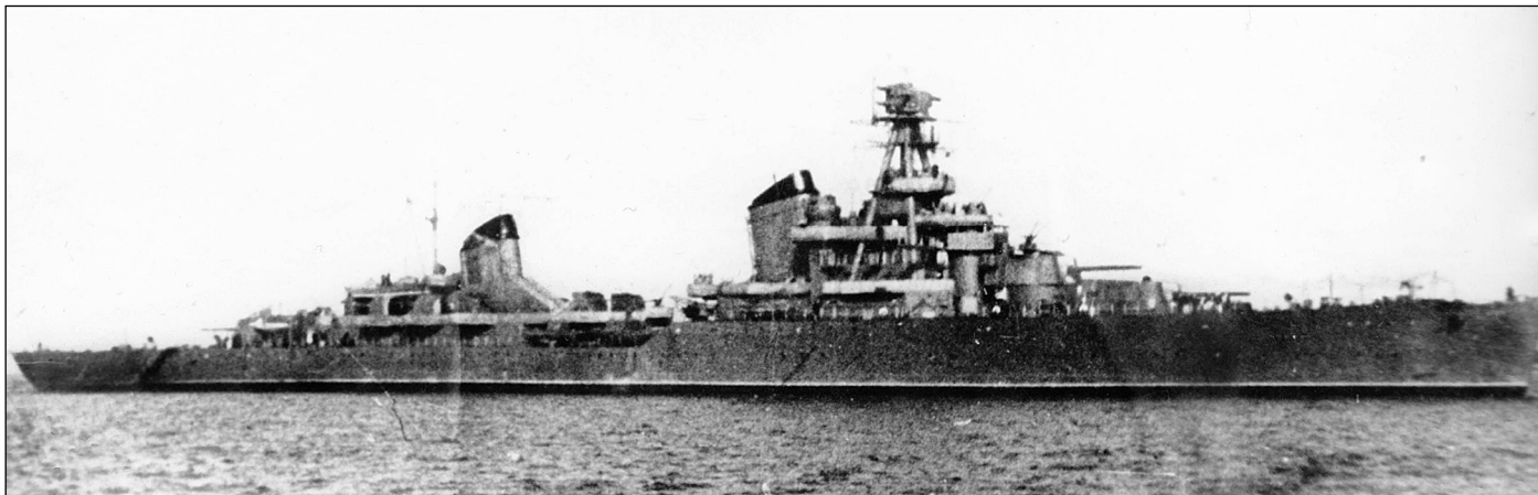
Крейсер «Киров» в 1945 г. На КДП и фок-мачте установлены антенны РЛС, счетверенные 12,7-мм пулеметы «Виккерс» демонтированы
