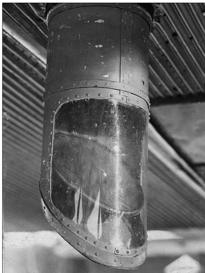
Перископ, установленный под центральной частью фюзеляжа ТБ-3
