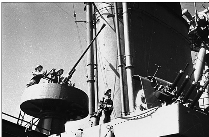
Установленные в декабре 1942 года на «Ворошилове» 37-мм автомат 70-К и 12,7-мм счетверенный пулемет «Виккерс»
