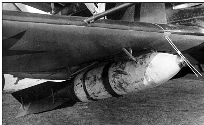
Авиабомба ФАБ-250 с закрепленной контровкой взрывателя
