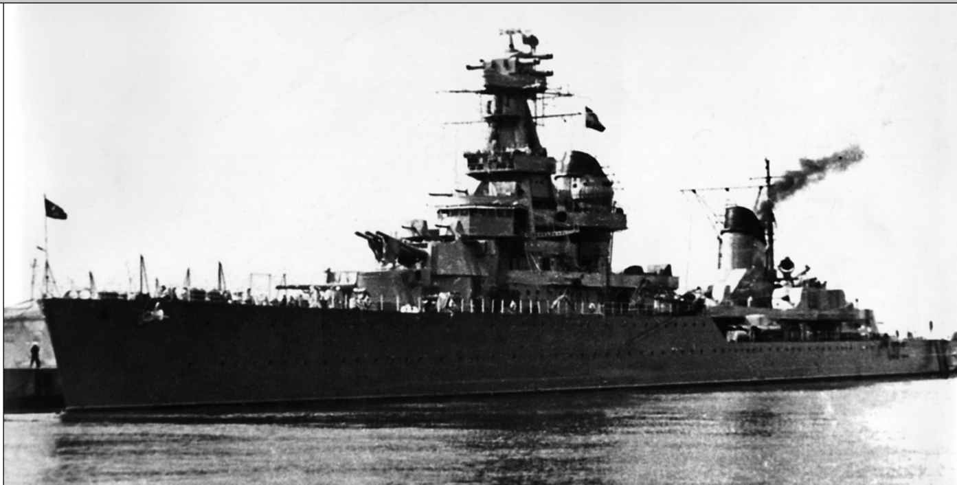
Крейсер «Киров» в 1945 г. На КДП и фок-мачте установлены антенны РЛС, счетверенные 12,7-мм пулеметы «Виккерс» демонтированы
