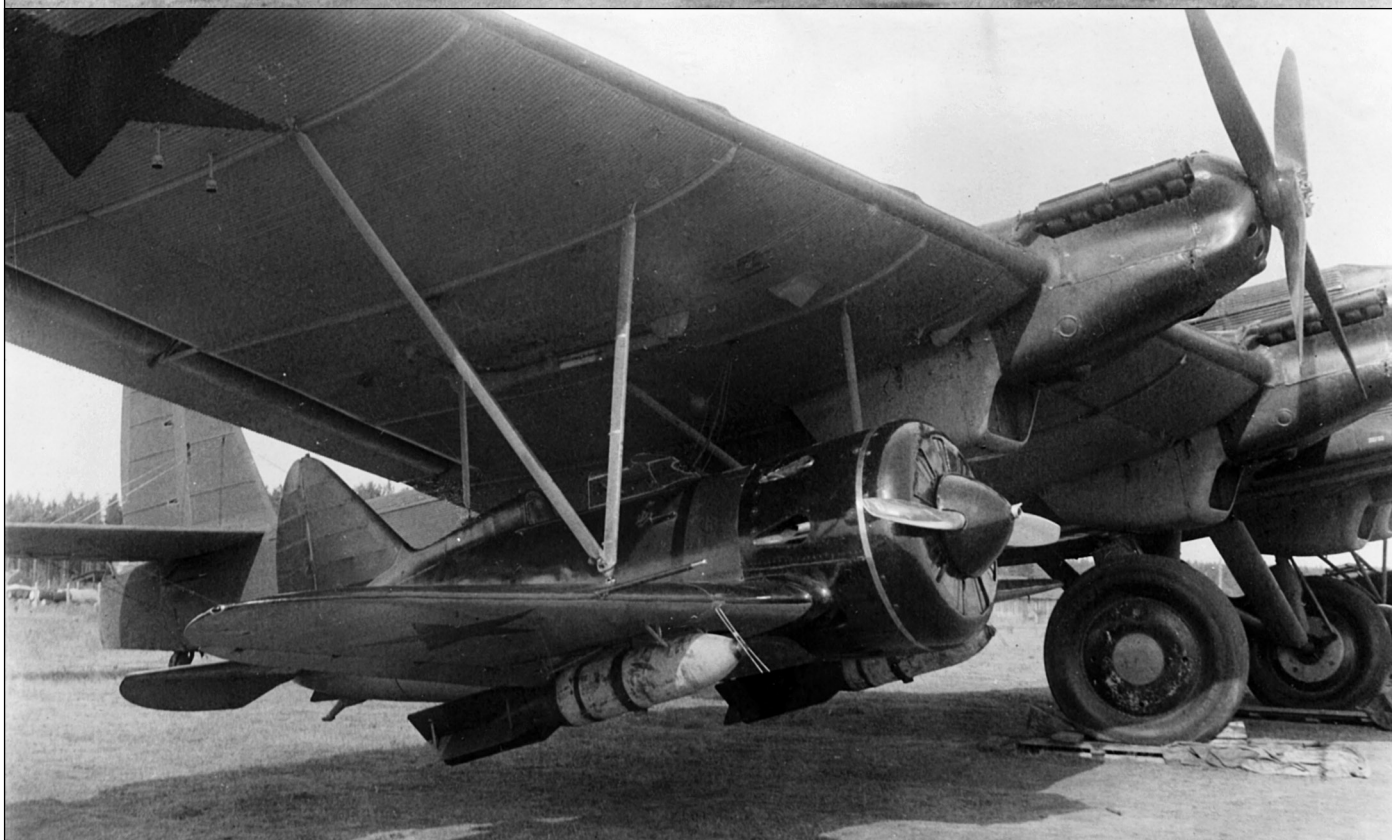
ТБ-3 4М-34РН + 2 И-16 М-25 на аэродроме НИИ ВВС в ходе проведения испытаний летом 1938 г.
