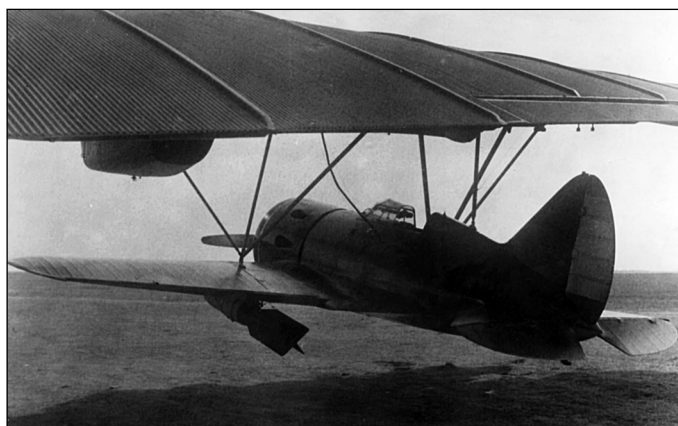
И-16 М-25 с двумя ФАБ-250 под крылом ТБ-3. Хорошо заметен шланг бензопитания
