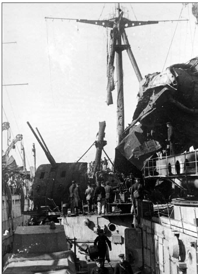
«Киров» после авианалета 24 апреля 1942 г.: разрушенная кормовая труба и перебитые опоры грот-мачты.
