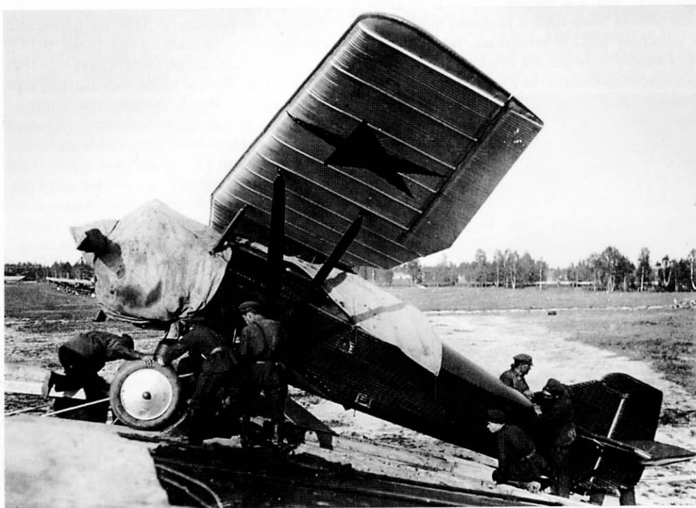
Процесс закатывания И-4 на крыло ТБ-1 по наклонной эстакаде
