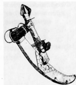
Костыль в сборе с поворотной трубой и амортизатором
