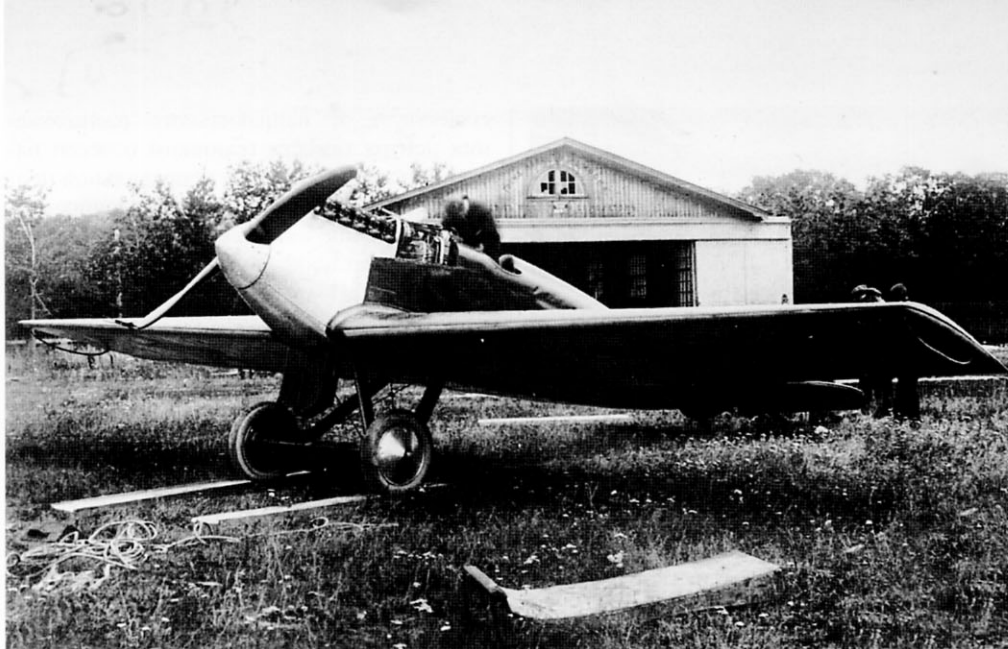
Третий опытный экземпляр ИЛ-400 позднее получил обозначение ИЛ-3 и стал образцом для небольшой серии, состоящей из 12 однотипных экземпляров. Самолет сфотографирован летом 1925 года перед ангаром, на котором написано: «Госуд. Авиационный завод Москва. Отдел испытаний самолетов»
