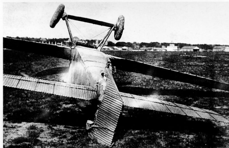
В центре и внизу: авария второго опытного ИЛ-4006, произошедшая 20 мая 1925 г. После совершения полета, во время пробеге, ИЛ-4006 перевернулся по причине поломки правого колеса. Летчик Ширинкин, управлявший самолетом отделался легкими ушибами
