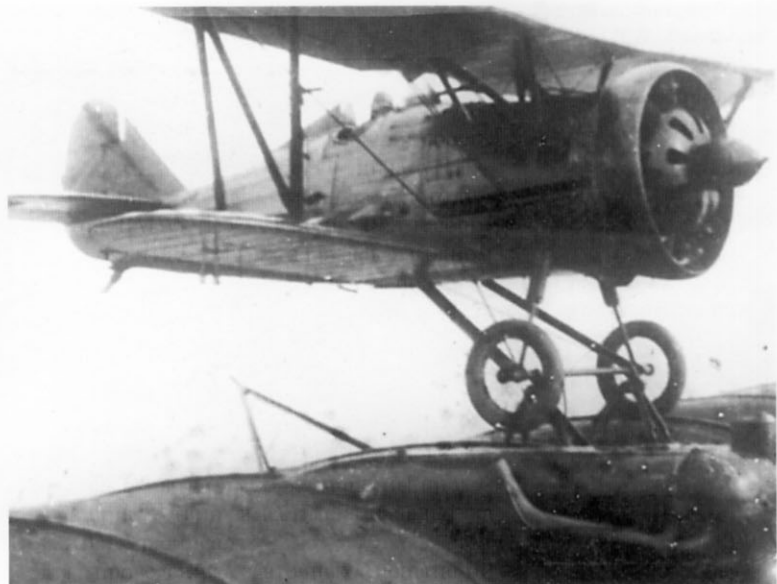
Момент отрыва И-5 от крыла самолета-носителя ТБ-3
