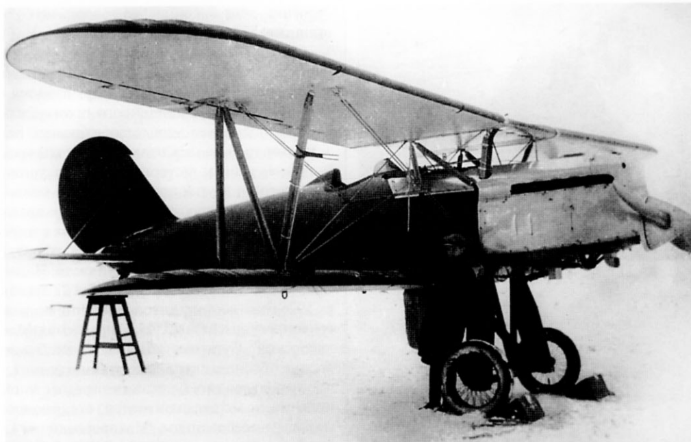
Истребитель И-3 выставлен в линию полета для прове- дения его нивели- ровки
