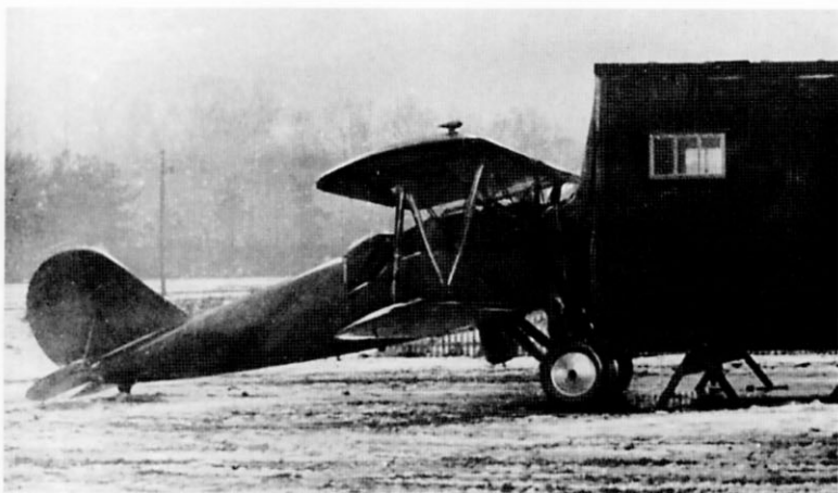
Ремонт двигателя М-17 самолета И-3 в специальном передвижном ангаре, известном как «тепляк»
