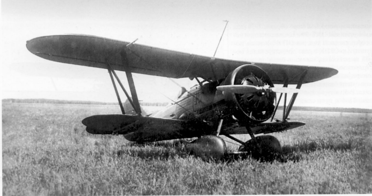
Истребитель И-5 М-22 № 21117 был определен как эталон для серии 1933 г. Данный экземпляр отличался уширенными поворотными стойками, которые должны были облегчить выход из штопора. Фото датировано 15 июня 1933 г.
