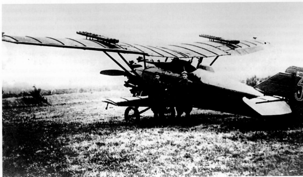
И-4 со строевым номером 4 оборудован шестью реактивными орудиями трубчатого типа для снарядов калибра 82 мм. Ржевский полигон под Ленинградом. 1935 г.
