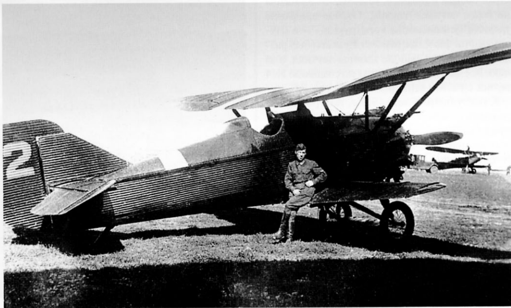
И-4 на полевом аэродроме со знаками быстрого распознавания (белыми поперечными полосами), обычно используемыми во время учений
