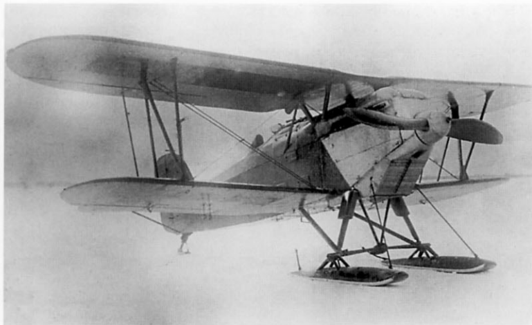
Эталонный истребитель И-7 №4449 с измененным хвостовым оперением во время испытаний на лыжах зимой 1933 г.
