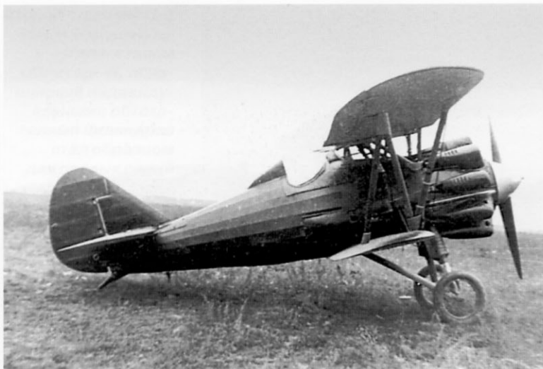
И-5 первых серий авиазавода №1 образца 1931 года. Самолеты отличались дополнительными прорезями охлаждения («жабрами») на обтекателях цилиндров двигателя
