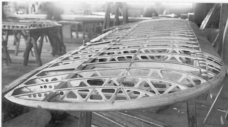
Законцовка крыла первых серийных И-5 выклеивалась на формообразующем стапеле из дерева, а затем обрабатывалась
