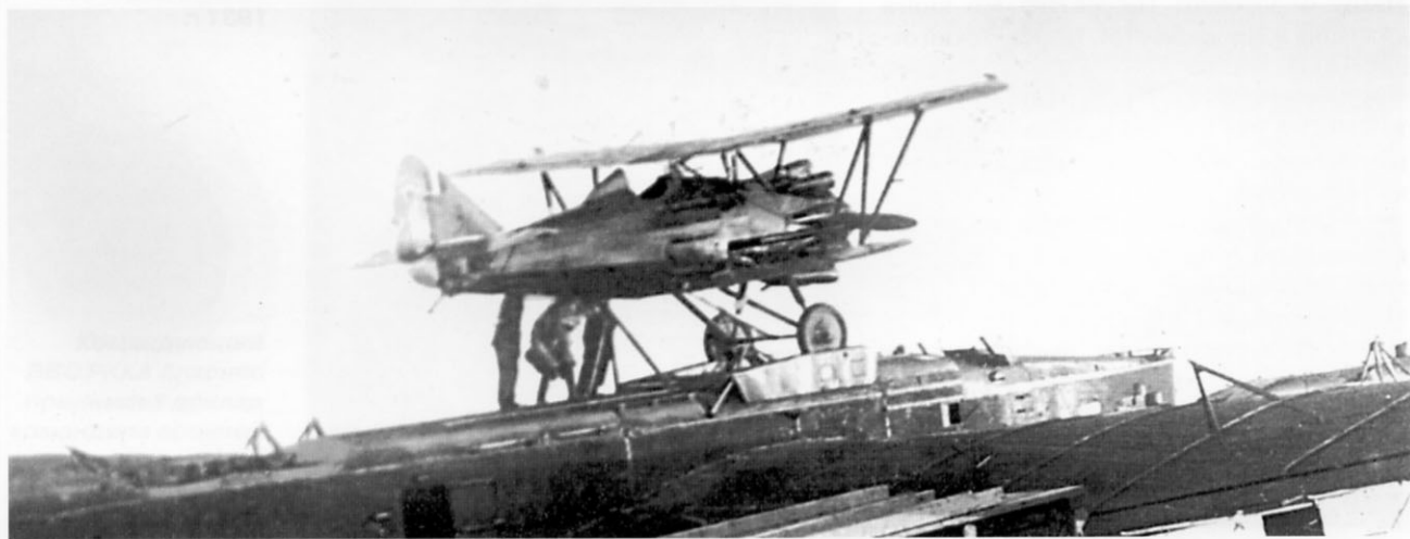
Истребитель И-5 из состава системы Звено-2 (З-2) установлен на фюзеляже бомбардировщика ТБ-3
