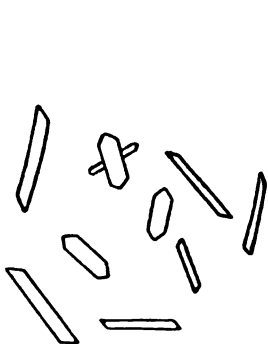
Рис. 200. Кристаллы Ce_2(C_2O_4)_3 \cdot 10H_2O , осаждающиеся из азотнокислого раствора.
