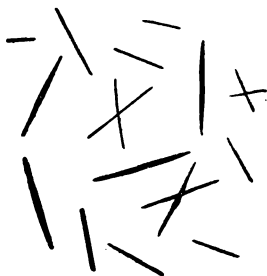
Рис. 219. Кристаллы диметилглиоксимата никеля (C_4H_7N_2O_2)_2Ni (красные).
