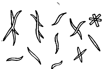
Рис. 181. Кристаллы \text{Sr}(\text{JO}_3)_2 \cdot 6\text{H}_2\text{O} .
