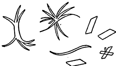
Рис. 180. Кристаллы \text{BaC}_2\text{O}_4 \cdot n\text{H}_2\text{O} .
