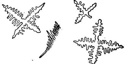
Рис. 21. Кристаллы \text{Zn}[\text{Hg}(\text{CNS})_4] , осажденные из нейтральных растворов.
