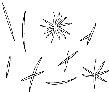
Рис. 240. Кристаллы \text{Zn}[\text{Hg}(\text{CNS})_4] .
