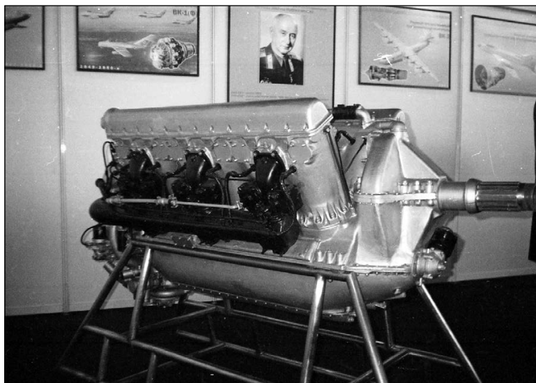
Двигатель жидкостного охлаждения М-103А
