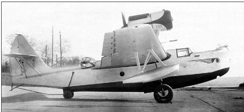
МБР-2 с мотором АМ-34 на перекатном шасси
