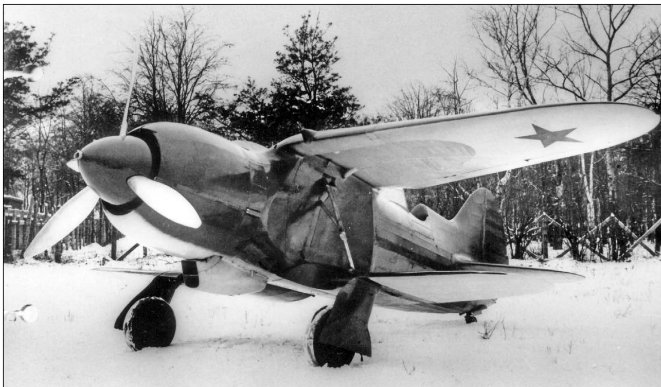
ИС-2 с двигателем М-88
