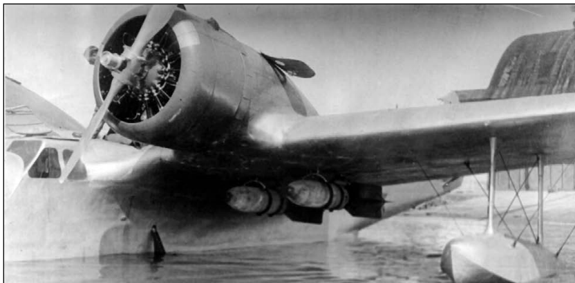
Морской дальний разведчик МДР-6 на перекатном шасси
