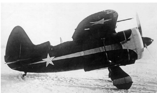
Первый экземпляр бимоноплана ИС в варианте биплана
