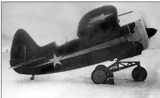
ИС со сложенным крылом на перекатном шасси
