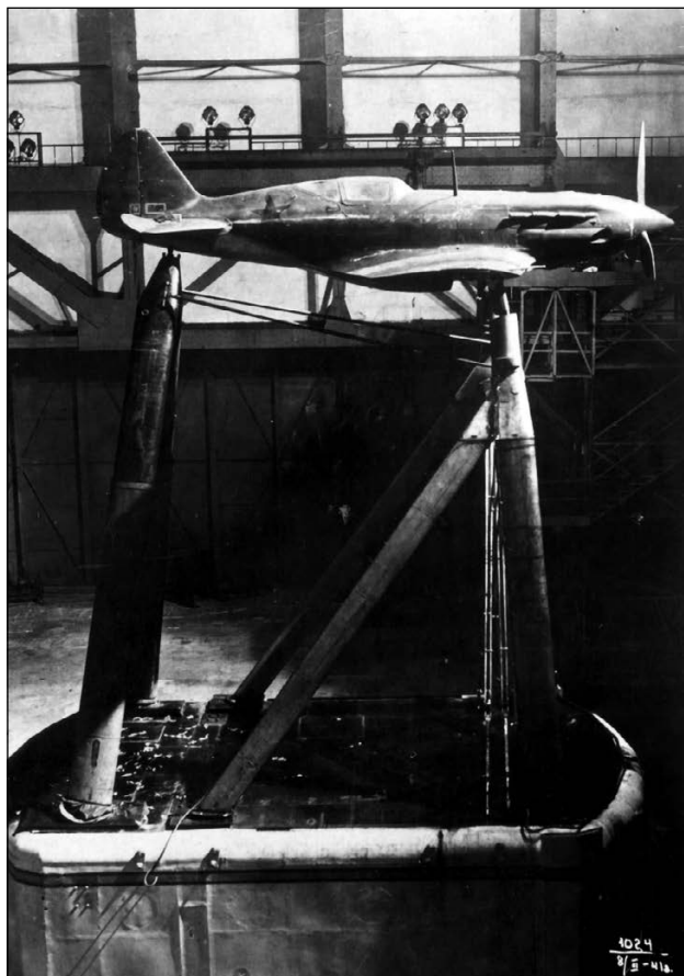
Испытание И-200 в аэродинамической трубе ЦАГИ
