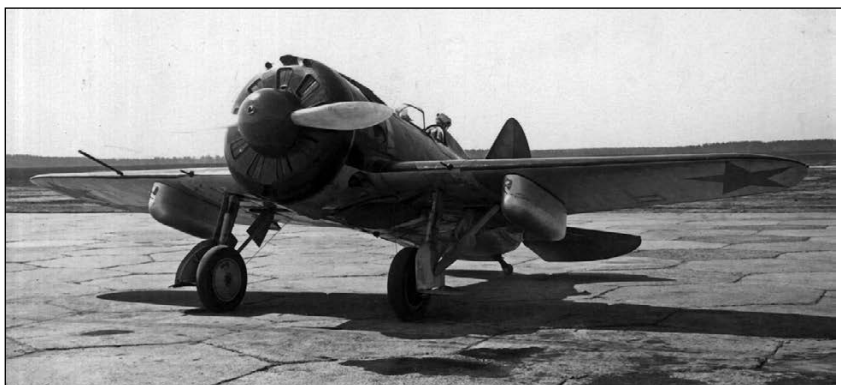
И-16 тип 24 с подвесными топливными баками
