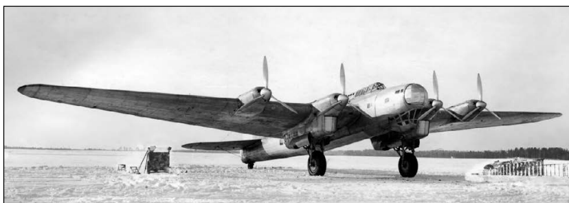
ТБ-7 с агрегатом центрального наддува
