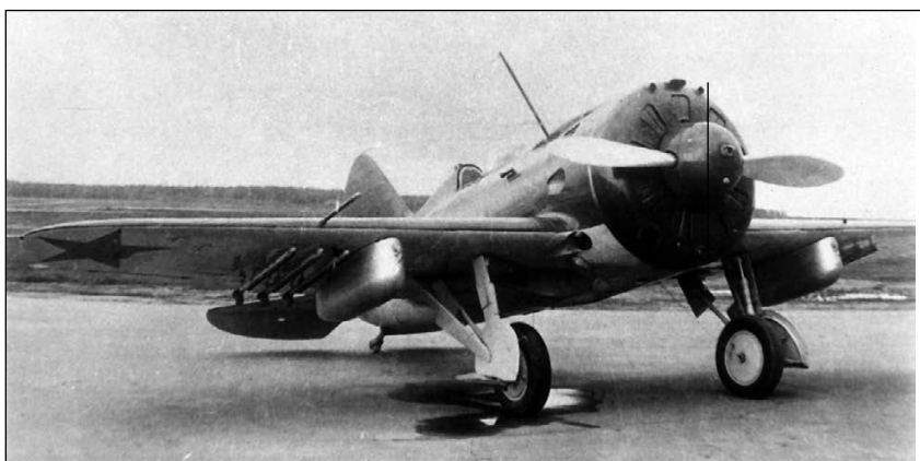
И-16 тип 29 с реактивными орудиями и подвесными топливными баками
