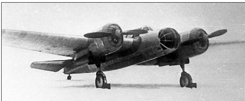
Бомбардировщик СБ с двигателями М-100
