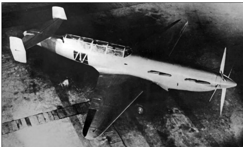
Бомбардировщик «С» с соосными винтами
