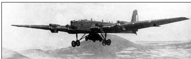
Транспортировка самолетом ТБ-3 броневывода на внешней подвеске
