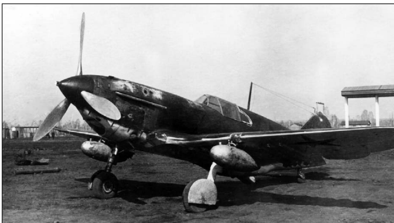
ЛаГГ-3 с подвесными топливными баками
