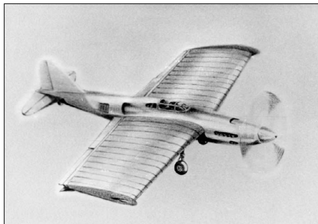
Рисунок самолета РКИ с крылом во взлетно-посадочном положении
