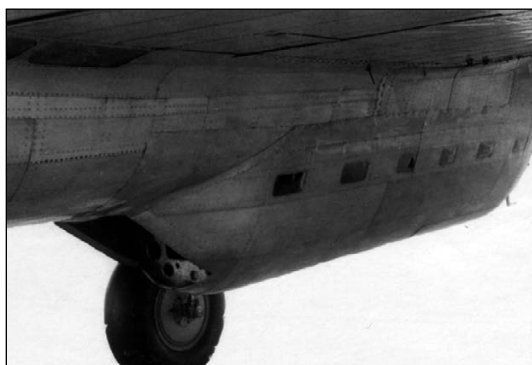
Подвесная десантная кабина для самолета ТБ-7
