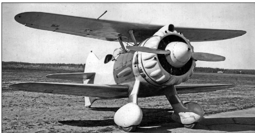
И-207 с мотором М-62
