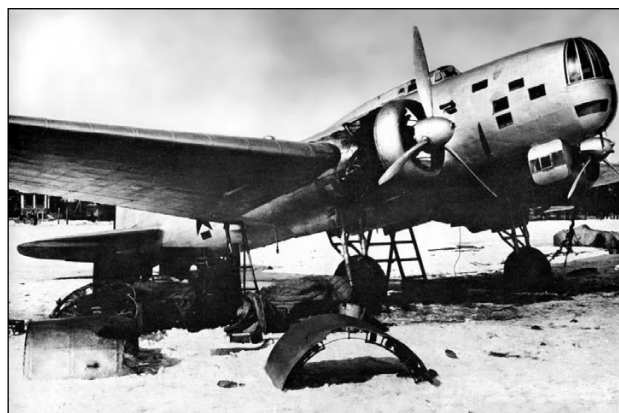
Профилактические работы на СБ с моторами М-103А
