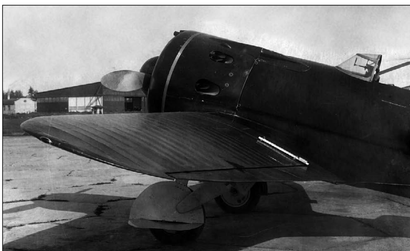
И-16 тип 24 с тканевой обшивкой крыла
