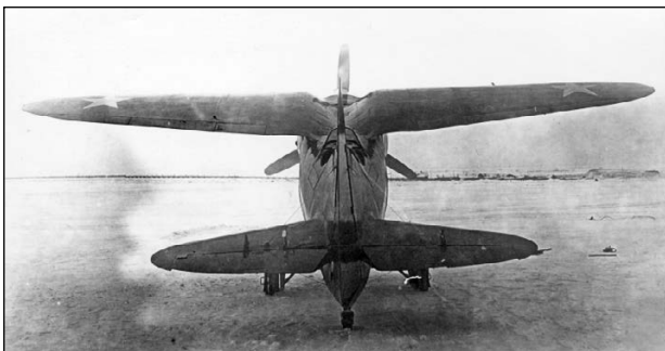
ИС со сложенным крылом на перекатном шасси
