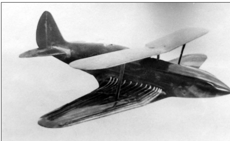
Модель пушечного бронированного штурмовика ПБШ
