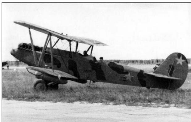
Основной разведчик ВВС КА Р-5 с подвесными грузовыми мешками
