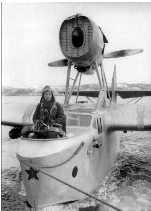
Буксировка МБР-2 с мотором АМ-34
