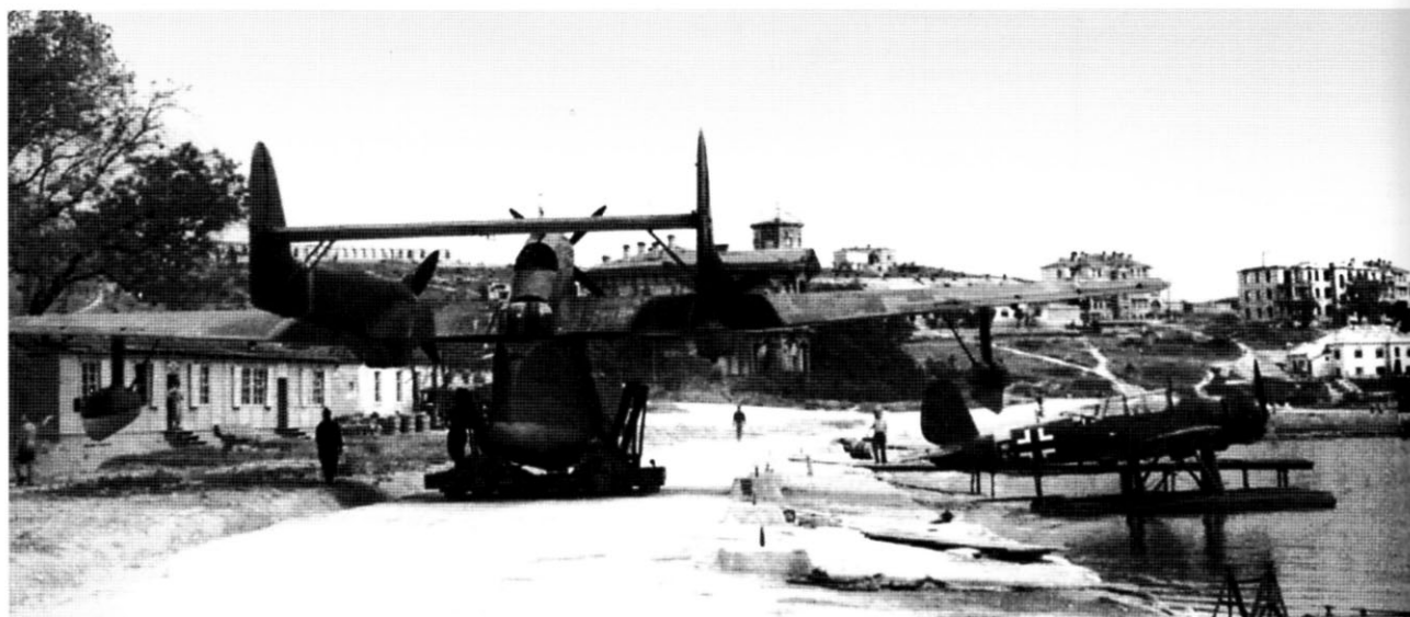
Немецкие гидросамолеты в бухте Севастополя в период Великой Отечественной войны (1942-44 гг.). На воде стоит поплавковый Ar 196 с опознавательным знаком 7R+?? из состава подразделения 1./SAG 125. На переднем плане снимка летающая лодка BV 138, установленная на перекатное шасси. Возможно, именно с этими самолетами в небе над Черным морем приходилось сталкиваться пилотам КОР-2
