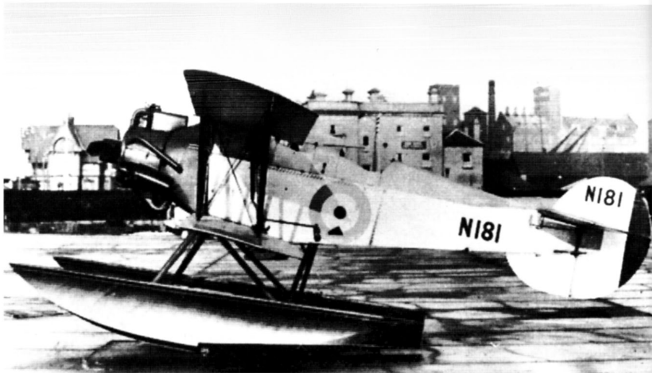
Гидросамолет Peto Parnall предназначен для использования с подводной лодки М-2
