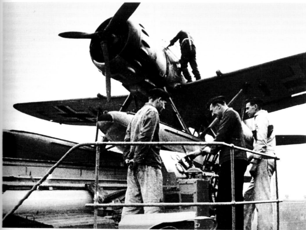
Немецкий корабельный разведчик Ar 196 на катапulte, размещенной на одном из кораблей Кригсмарине
