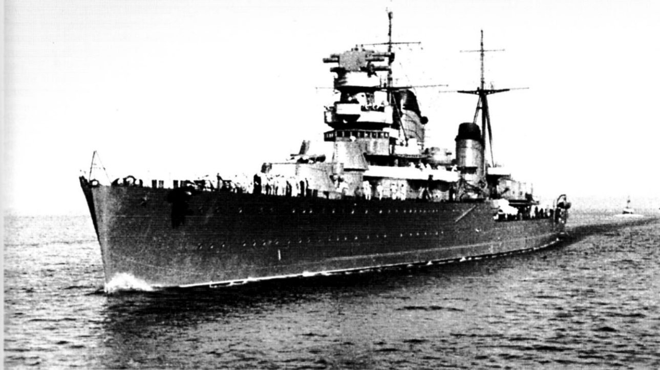
Легкий крейсер «Максим Горький» с установленным на катапulte ЗК-1 гидросамолетом КОР-1
