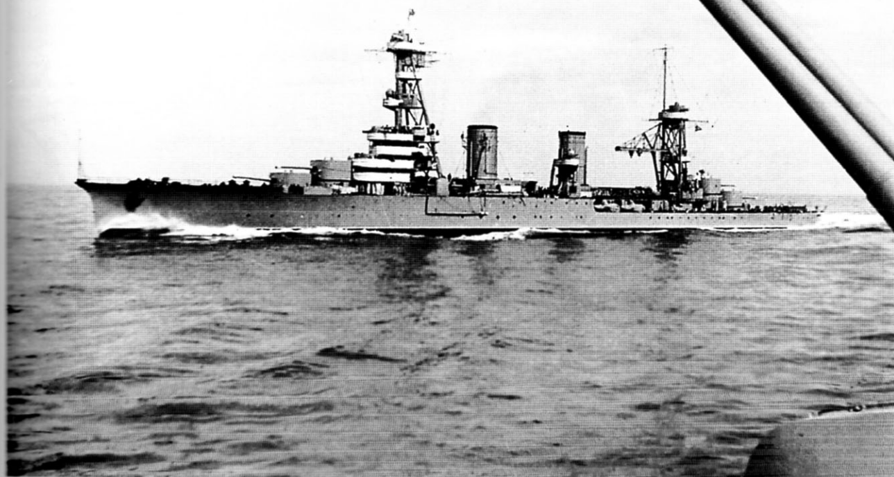
Крейсер «Красный Кавказ» после установки катапульты К-3. Самолет на представленном фото отсутствует
