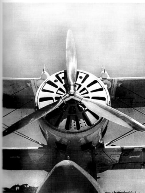
Вид на лобовую часть силовой установки первого опытного КОР-1. Данный экземпляр отличался моторным капотом с индивидуальными выхлопными патрубками и оригинальным лобовым диском с многочисленными окнами охлаждения двигателя. При этом заметно, что отверстия охлаждения даже при максимальном закрытии оставляли заметные щели для прохождения воздушного потока
