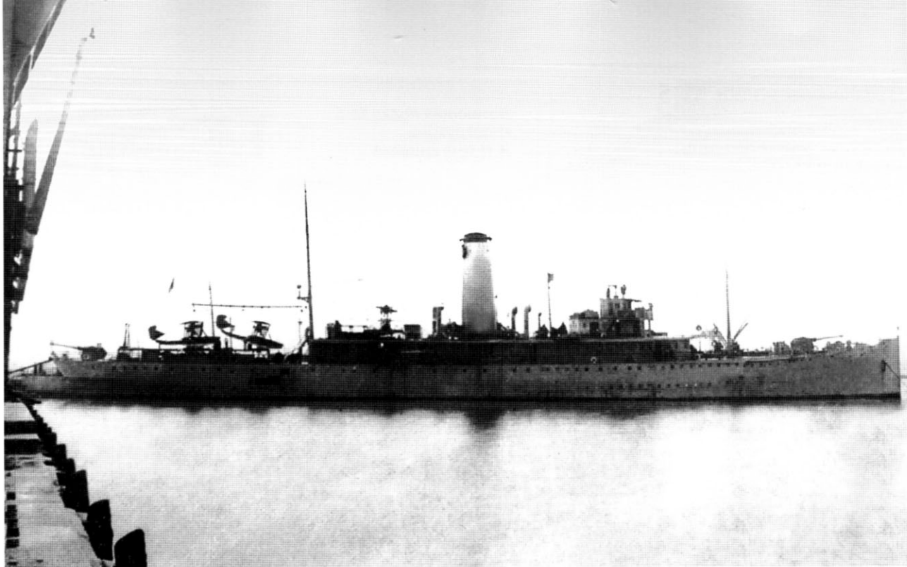
Черноморский гидрокрейсер «Румыния», переоборудованный в 1916 г. из грузо-пассажирского парохода «Romania», поднимал на борт 3–4 летающих лодки М-9
