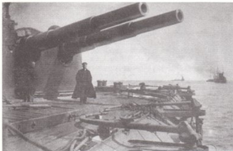
Кормовая 305-мм башня броненосца «Полтава». Хорошо видны заваленные по-боевому шлюпбалки и леера, а также уложенный на палубе заборный трап.
