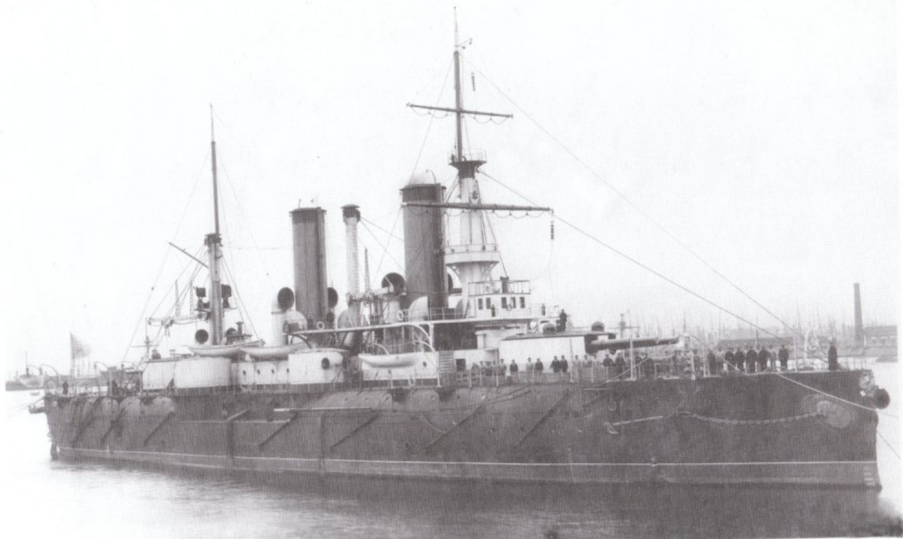
«Полтава» во время ходовых испытаний, осень 1898 г. 152-мм орудия и прожекторная площадка на фок-мачте еще не установлены.
