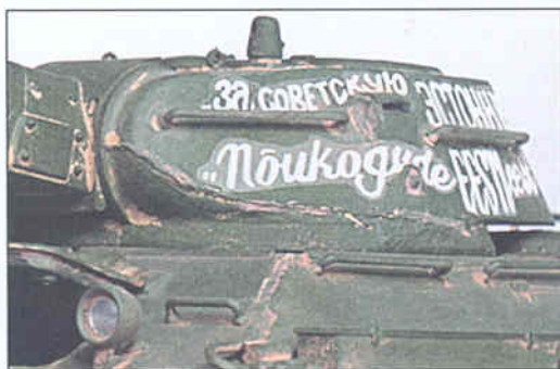
Жесткая лаковая подложка декалей и матовая краска заставляют декаль «серебриться» — под лаком остается воздух между микронеровностями краски (именно они и делают краску матовой)...
