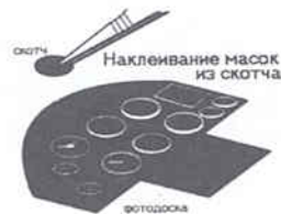
Приборная доска модели самолета Amiot 143 в масштабе 1/72, изготовленная методом фотопечати и склеенная из фальшпанели с отверстиями и собственно доски с циферблатами приборов
