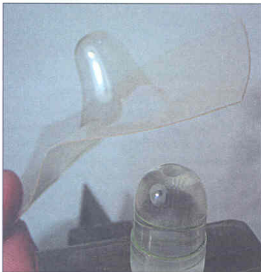
Секунда и остывший блистер можно снимать с оправки для демонстрации, (на самом деле его предстоит еще обрезать, ради чего вновь надеть на оправку)
