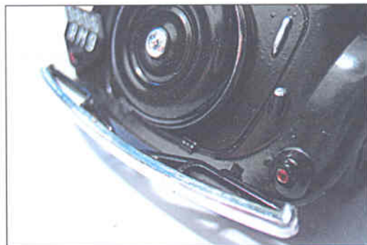
Габаритные огни Citroen 11CV в масштабе 1/48 от Tamiya сделаны очень просто — наклеены вырезанным пробойником кусочки самоклеющейся фольги, а на них нанесены капельки прозрачного красного акрилового лака Tamiya
