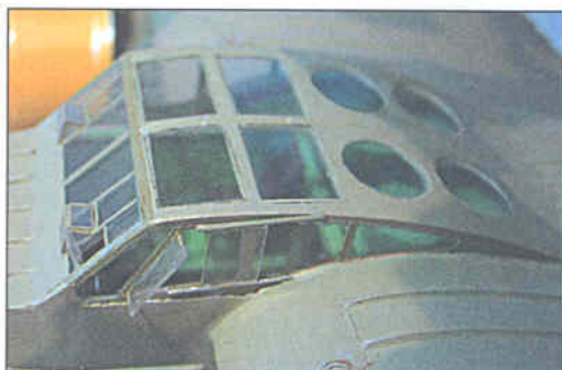
Кабина модели Bloch MB 200 в масштабе 1/72, изготовленная самостоятельно по технологии «кабин с плоскими стеклами»
