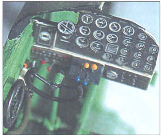
Приборная доска модели самолета Amiot 143 в масштабе 1/72, изготовленная методом фотопечати и склеенная из фальшпанели с отверстиями и собственно доски с циферблатами приборов
