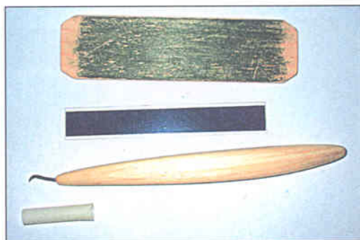
Полный рабочий комплект: «клювик» для нарезки расшивки, гибкая противоскользящая линейка и оселок для заточки лезвия «клювика»
