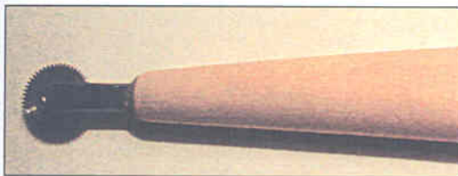
Один из видов самодельного «колесика» из часовой шестеренки для «накатки» заклепочных швов
