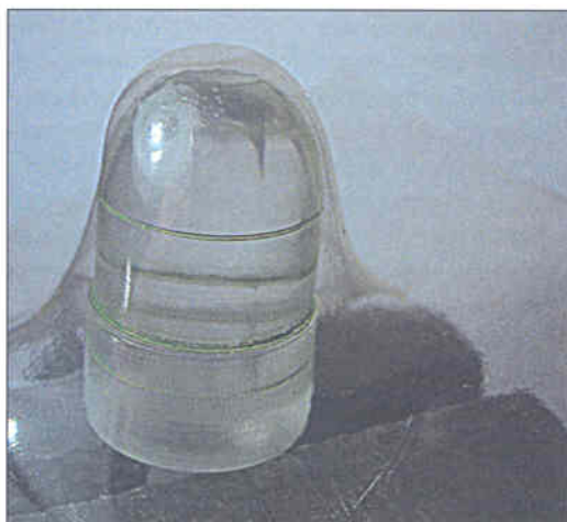
Процесс изготовления блистера. Этап «натягивания» разогретого «стекла»
