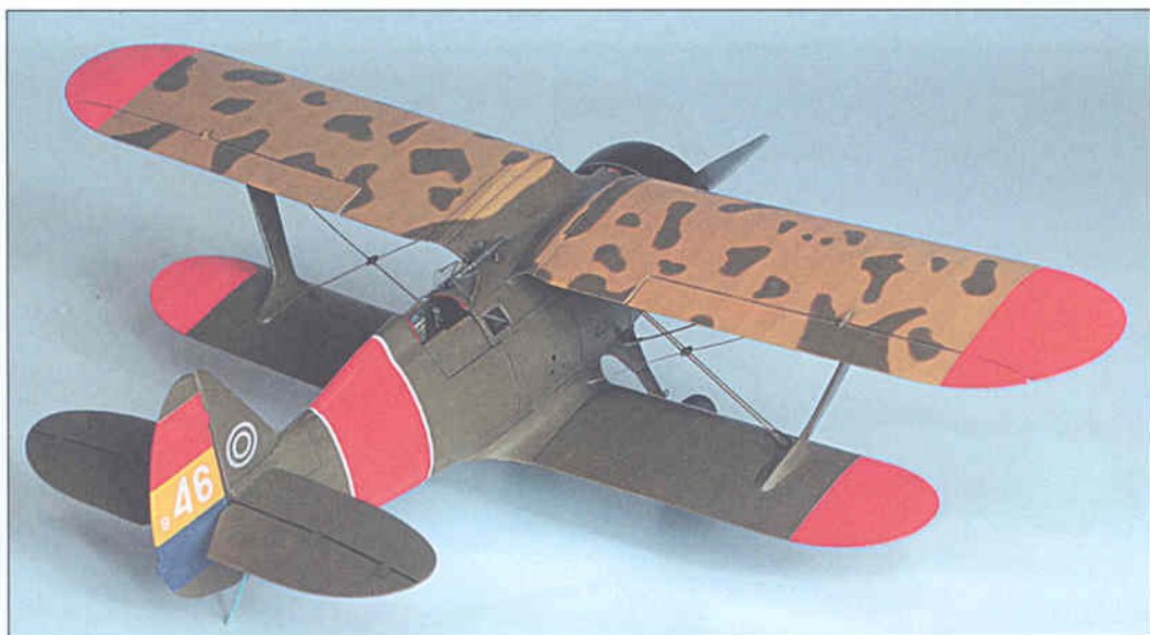
На крыле И-15 в масштабе 1/48 зеленые пятна накрашены без масок и обтерты по краям смоченным в бензине тампоном. Этот метод хорошо работает при использовании нитрокраски, если, конечно, просушить базовый цвет хотя бы сутки
