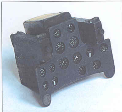
Приборная доска истребителя И-15 в М 1/48 фирмы Rest Models, изготовленная методом «бутерброда»
