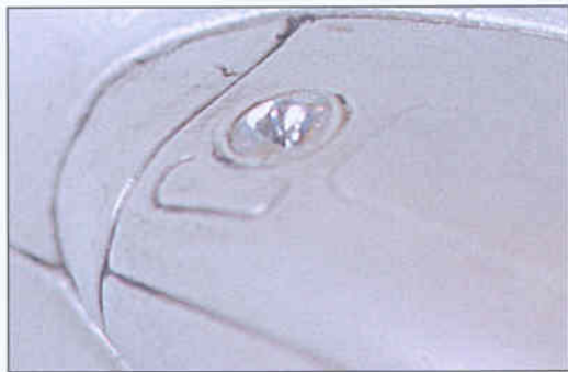
На Ан-12 в масштабе 1/72 фирмы «Роден» стекла фар входят в набор, но рефлекторы пришлось самостоятельно выдавить из фольги и вклеить в рассверленное углубление на мотогондоле
